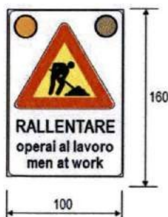
Figura 18: pannello composito di pres segnalazione per lavori eseguiti lungo le corsie di decelerazione o sulle rampe di svincolo, dotato di 2 lampade a led ad alta efficienza diam. 200 mm. Superficie della targa non inferiore a 1,5 mq con lato del triangolo lavori in corso non inferiore a 90 cm. Posizionamento sul margine destro in coincidenza dell'ago di inizio della decelerazione e ripetuto in condizioni di non perfetta visibilità.
