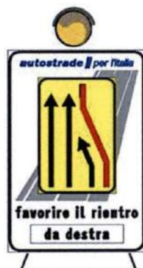
Figura 5: pannello composto di presegnalazione in destra modificabile con lamierini integrato con lampeggiatore a led alta efficienza diam. 300 mm alimentato con batteria da autovettura. Dimensioni 135x200 cm. Posizionamento sul margine destro su cavalletto con anticipo rispetto al cartello "lavori in corso" come da schemi in cui se ne prevede la dotazione.
