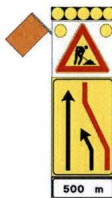
Figura 12: "segnale mobile di preavviso" fig. Il 400 Art.39 Reg. da impiegare su tratti autostradali con corsia di emergenza per la chiusura di una o più corsie di transito (la figura esemplifica la chiusura della corsia di marcia in dx). E' integrato con set di 6 lampade a led ad alta efficienza luminosa diam. 300 mm (con possibilità di lampeggio sincrono e sequenziale) e con sbandieratore elettromeccanico posto in alto sul lato esposto al traffico.
