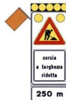
Figura 14: "segnale mobile di preavviso" derivato dalla fig. Il 400 Art.39 Reg. da impiegare per lavori sulla sola corsia di emergenza. E' integrato con set di 6 lampade a led ad alta efficienza luminosa diam. 300 mm (con possibilità di lampeggio sincrono e sequenziale) e con sbandieratore elettromeccanico posto in alto sul lato esposto al traffico.
